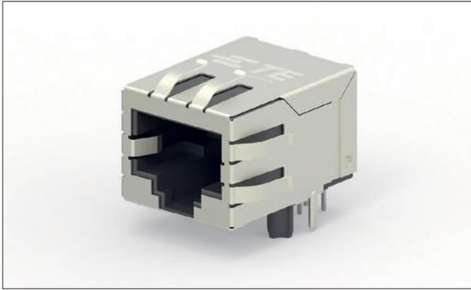
マグネットコイル（パルストランス）を搭載した産業用RJ45コネクタは、ケーブルから物理層までの産業用イーサネットの高集積接続技術ソリューションを提供します。マグネットコイルをコネクタに搭載する事により、EMIノイズシールド性能が大幅に向上し、より信頼性の高い接続信頼性が可能になります。1×1の1ポート縦型と横型、1×2、2×1の2ポートを標準化したポートフォリオは、産業用アプリケーションにおける、お客様に最適なソリューションを提供します。TEのマグネットコイル搭載 産業用RJ45ジャックコネクタは、最新のリフロー実装工程への対応を始め、耐久性の向上による高い信頼性、広い温度範囲、長期製品寿命など、特定の産業分野におけるご要望にお応えします。
