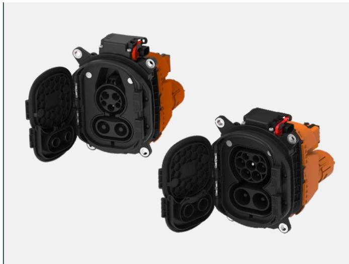
高電圧車両向けHIVONEXポートフォリオのひとつであるTEコネクティビティ(TE)の充電インレットは、産業用および商用車向けに特別に設計されており、高速で安全な充電に最適です。新たに追加された当社の高出力充電インレットは、連続500Aまでの高出力充電をサポートするように設計されており、過酷な環境で動作し、寿命が長い車両や機器のダウンタイムを短縮し、生産性を最大化します。
