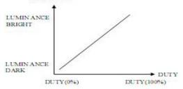
NOTE (2): PWM SIGNAL=0~3.3V · OPERATION FREQUENCY: 20±5KHz
