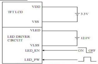
NOTE (1): ADJUST THE PWM SIGNAL IN ORDER TO CONTROL LED BACKLIGHTS
